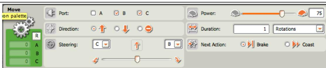
Il pannello di configurazione contiene i parametri dei blocchi come ad esempio la potenza dei motori o le soglie dei sensori e permette di modificarli. I dettagli di configurazione dei blocchi saranno trattati in seguito.
