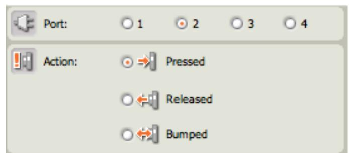
Configurazione del blocco *Logic*:
