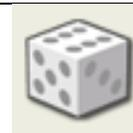
Il blocco *Random* genera un numero aleatorio compreso in un intervallo definito tramite due *data wire* oppure nel pannello di configurazione. Il numero generato viene prodotto sull'uscita del blocco.
