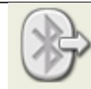
Il blocco *Send Message* permette di inviare un messaggio ad un altro NXT tramite l'interfaccia Bluetooth.
