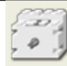
Il blocco *Motor\** permette di comandare in un singolo motore RCX collegato ad una porta di uscita tramite il cavo di conversione NXT/RCX.
