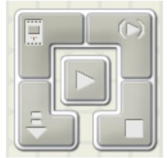
Il controller permette di caricare i programmi (o parti di essi) su un NXT connesso al computer (con USB o Bluetooth) e di eseguirli. Tramite il controller è anche possibile modificare le impostazioni dell'NXT.
