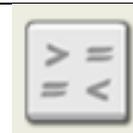
Il blocco *Compare* serve a confrontare due valori numerici. Gli operandi possono essere forniti tramite i *data wire* di tipo logico A e B, oppure predefiniti nel pannello di configurazione del blocco. Il blocco *Logic* compara i due operandi e produce un risultato di tipo logico (vero/falso) sul *data wire* di uscita.
