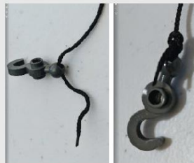
Passo 1: Realizzare un nodo quadro al capo della fune
